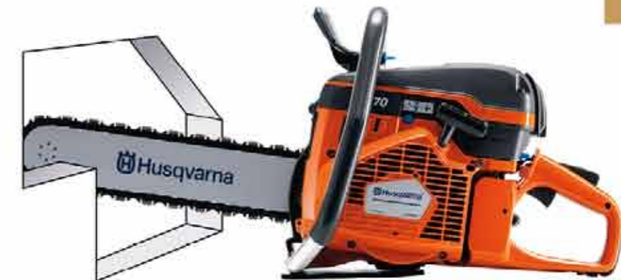
K 970 Chain umožňuje řezání malých otvorů 11 x 11 cm a je ideální pro otvory s nepravidelnými tvary.
