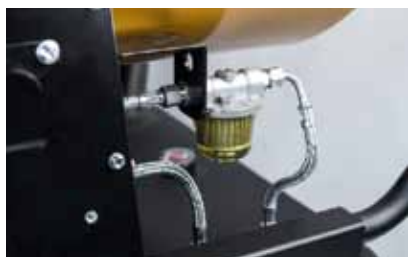
Předehříváč paliva na objednávku, palivový filtr venku.
