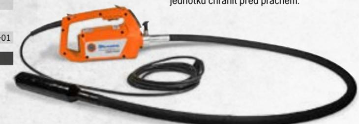
Vibrace v našich mechanických vibrátorech vytváří kyvadlo točící se v hlavě vibrátoru. Flexibilní rotující hnací hřídel přenáší přes hadici výkon z napájecího zdroje mechanicky na kyvadlo. Pohonnou hřídel může pohánět benzinový či elektrický motor. Pokud se jim dostává patřičné údržby, jsou mechanické vibrátory odolné a spolehlivé.
