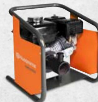
Systémy AA a AZ jsou poháněny benzinovými či naftovými pohonnými jednotkami s nízkou spotřebou paliva. Ty jsou vybaveny osvědčenými motory od společností Lombardini (nafta) a Honda (benzín), které zaručují spolehlivý provoz za všech okolností.
