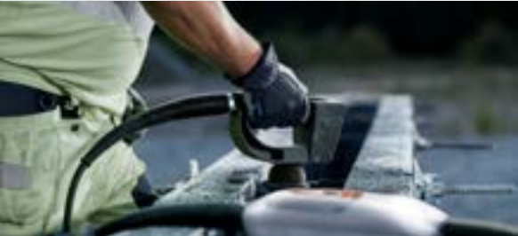
Verze Smart-E nabízí pistolovou rukojeť, která omezuje vibrace ruky/paže.
