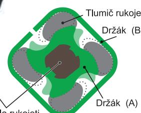
Snižuje vibrace z hlavní jednotky pomocí čtyř tlumičů stačovaných rotujícím držákem (A).
